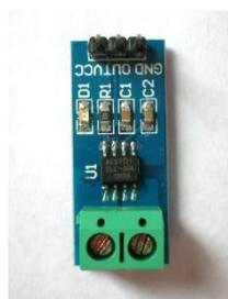
Figura 6. Sensor de corriente ACS712
