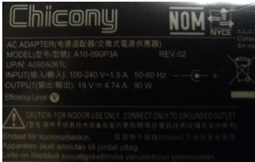
Figura 51. Características técnicas de cargador de portátil.
