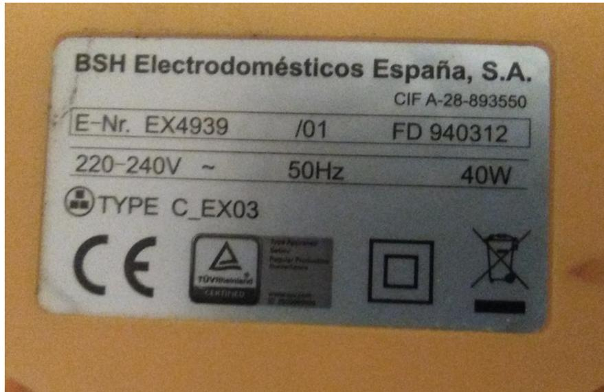
Figura 49. Características técnicas de exprimidor eléctrico.
