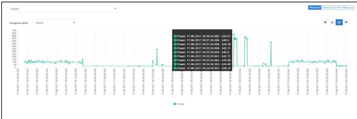
Figura 66. Detalle de consumo de potencia durante séptima etapa de prueba (secador de pelo)
