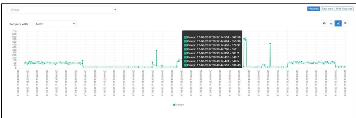
Figura 67. Detalle de consumo de potencia durante octava etapa de prueba (secador de pelo)
