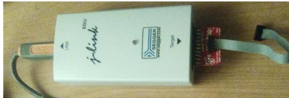
Figura 14. Interfaz JTAG para la carga del código en las placas OpenMote
