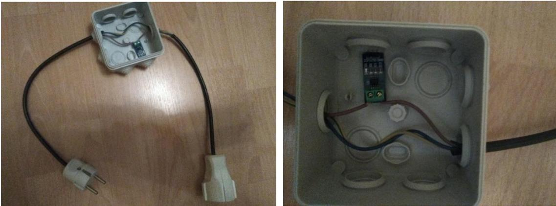
*Figura 9. Montaje para la conexión del sensor a la línea.*
