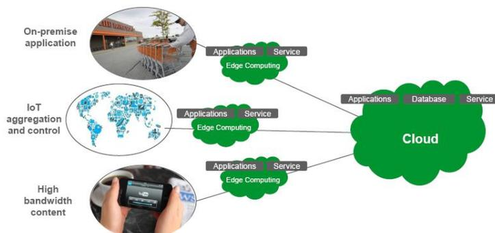
Ilustración 4: Diagrama básico de Cloud computing con dispositivos en el Edge [15]
