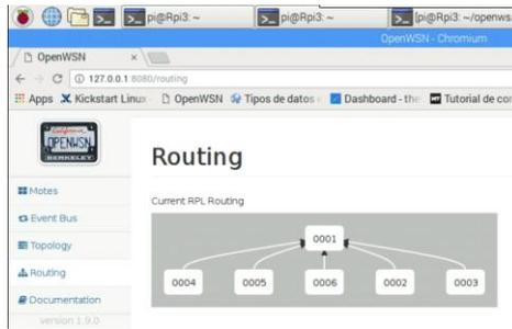
Ilustración 76: Creación de red WSN de la aplicación Edge, nodo #0001 como DAG Root
