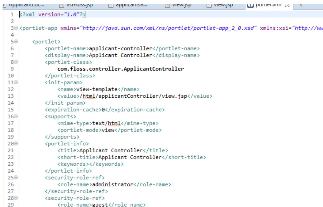
Ilustración 40 Edición Portlet.xml. Definición ApplicantController.
