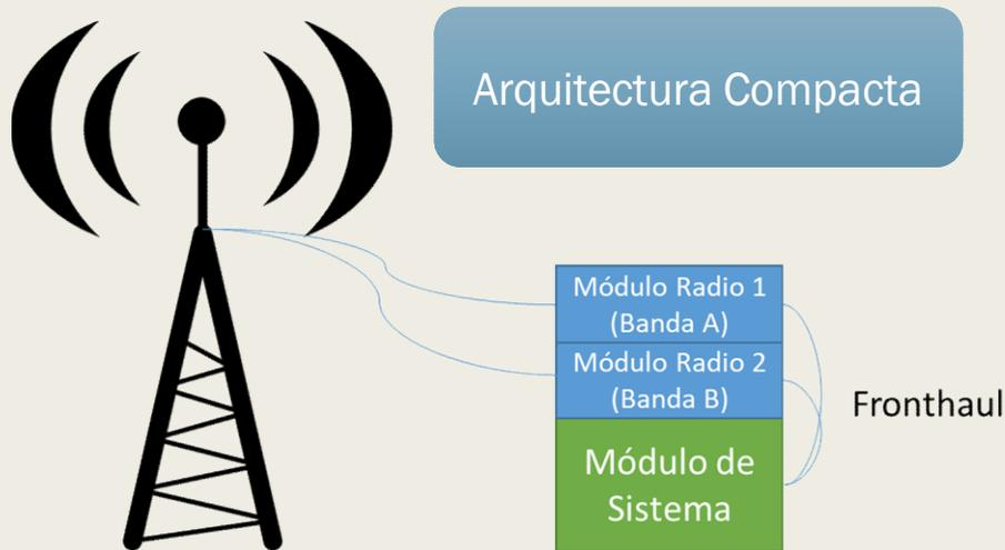
El módulo radio y el módulo de sistema se encuentran colocados y la longitud del *fronthaul* es de unos pocos centímetros.
