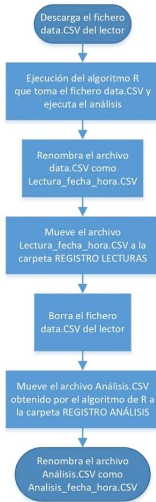
*Ilustración 34. Diagrama de flujo script de monitorización.*
