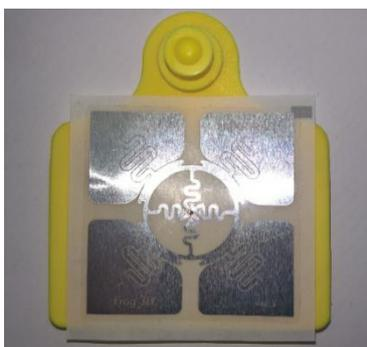
*Ilustración 46. Tag FROG 3D excede las dimensiones del crotal tipo C.*
