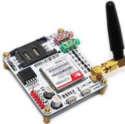
*Ilustración 26. Módulo GSM.* [21]
