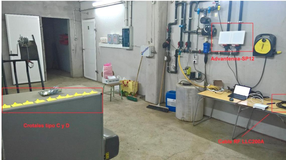
*Ilustración 47. Montaje del nuevo sistema RFID para el segundo ensayo.*
