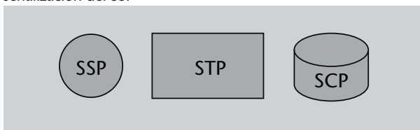
Figura 3. Representación gráfica de los tres tipos de puntos de señalización del SS7
