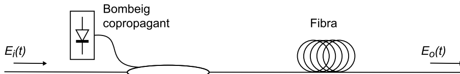
Figura 10. Esquema genèric d'un amplificador Raman amb bombeig copropagant
