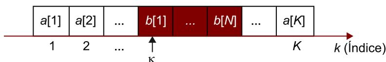
En la figura se muestra el procedimiento que se sigue para sincronizar la trama: hay que buscar el inicio (índice  $\kappa$ ) de la palabra inequívoca  $b[1], \dots, b[N]$  dentro de un vector de  $K$  símbolos  $a[1], \dots, a[K]$ . Estos símbolos se observan a la salida del filtro adaptado con un error de fase todavía no resuelto y en presencia de ruido.
