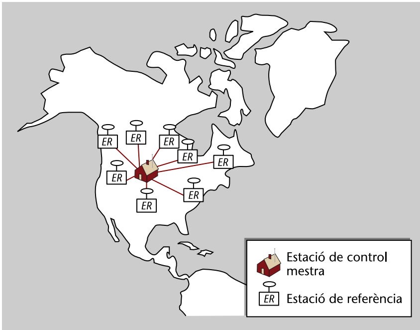
Figura 3. Principi de funcionament de DGPS d'àrea estesa
