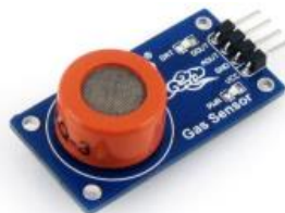
Figura 11. Sensor de gases MQ-3 con salida analógica. Fuente: sparkfun.com
