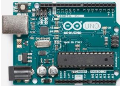
Figura 13. Placa de desarrollo Arduino UNO.
