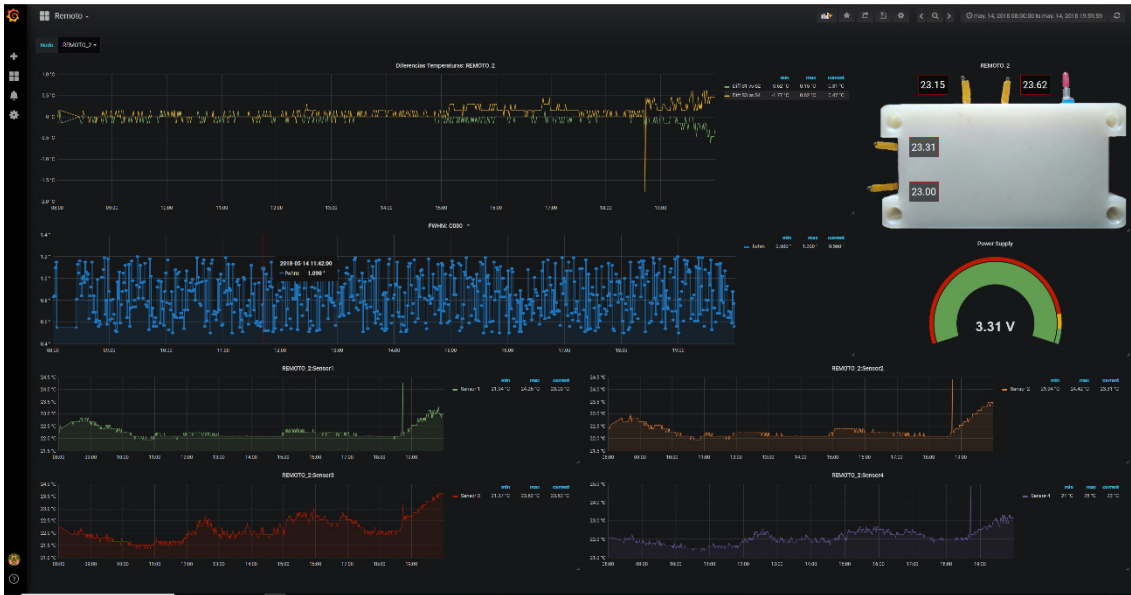
Ilustración 36. Interface Web desarrollado con Grafana del sistema de monitorización de un nodo. Se puede observar que se monitoriza el nodo “REMOTO_2”, el nodo a monitorizar es seleccionable desde el desplegable situado en la parte superior izquierda. En la gráfica superior (amarilla y verde) se muestra la diferencia de temperatura entre pares de sensores (1vs2 y 3vs4), justo debajo, en azul, el valor de FWHM de las imágenes. Las cuatro gráficas inferiores muestran los valores históricos de los cuatro sensores que componen el nodo. Todas las gráficas incluyen el valor actual, el máximo y el mínimo. Finalmente, a la derecha se muestran una imagen del nodo con los valores actuales de temperatura de sus cuatro sensores y el valor de voltaje de la tensión de alimentación.
