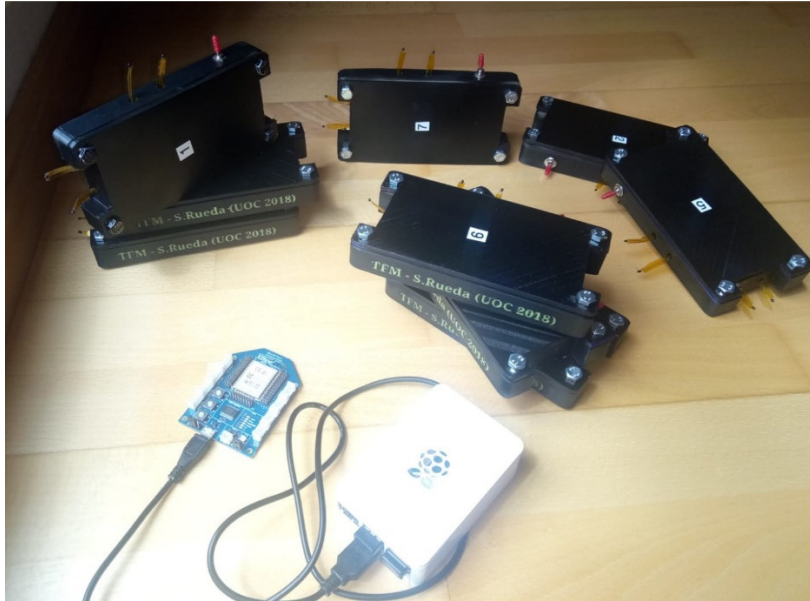
Ilustración 44. Vista de todos los nodos finalizados. Como se observa todos los nodos remotos han sido pintados de negro y etiquetados para su identificación. Por otra parte, como nodo colector se usa uno de los adquiridos en el Digi-Mesh Kit conectado a una raspberry pi model b vía serie mediante cable USB y la placa de desarrollo correspondiente
