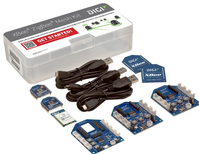
Ilustración 24. Elementos que integran el Digi Zbee Zigbee Mesh Kit y que ha sido adquirido para la realización de las pruebas iniciales dentro de este TFM [68]
