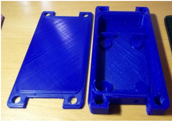
Ilustración 30. Caja diseñada para alojar la electrónica. Superior izquierda, visión lateral de la caja. Superior derecha, se observan los orificios para salida de dos termistores e interruptor. Inferior izquierda, el interior de la caja con el compartimento para alojar la pila de 9v, los soportes de la PCB y otros dos orificios frontales para la salida de los termistores. Inferior derecha, parte posterior de la caja con sus 4 imanes de neodimio para fijar la caja a la cúpula de metal. Tras la fabricación todas las cajas se han pintado de negro para evitar brillos y mejorar la uniformidad
