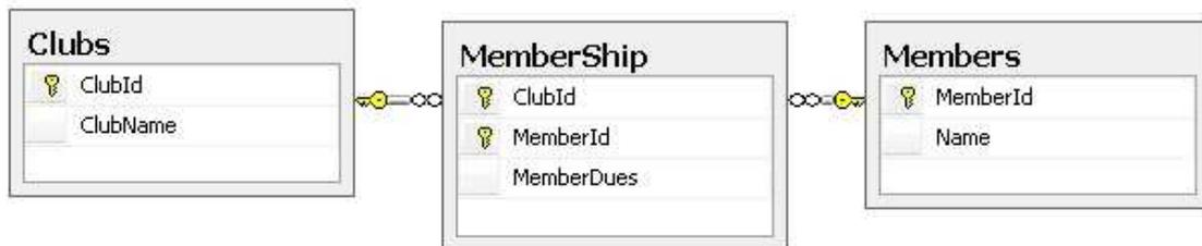
Después de crear las tablas, importaremos el modelo en EDM usando el modelo de la base de datos. A continuación se muestra el modelo de los datos que ha creado Entity Framework cuando importa las tablas.
