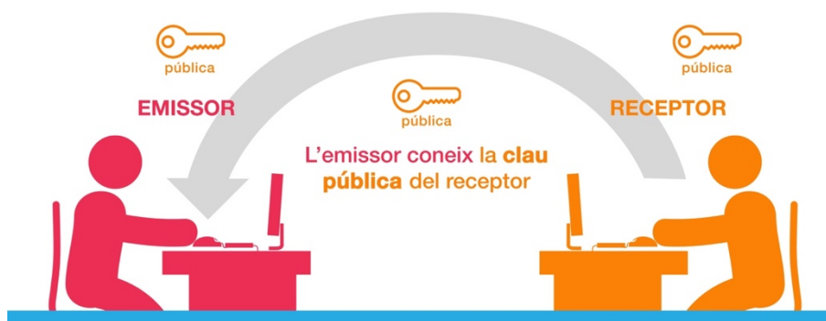
Figura 12: Criptografia de clau pública. L'emissor coneix la clau pública del receptor. Font: Elaboració pròpia.
