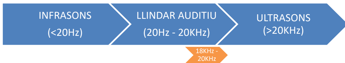
Figura 11: Llindar de freqüències audibles pels humans. Franja entre els 18KHz i els 20KHz utilitzada pel sistema proposat. Font: Elaboració pròpia.
