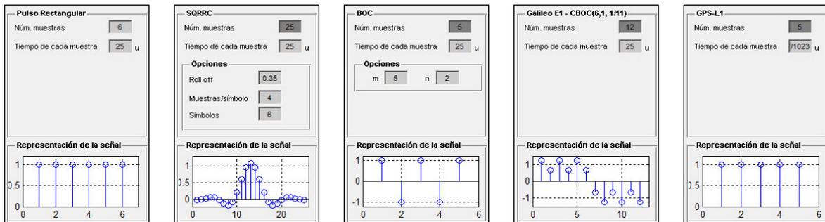
**Figura 46:** las diferentes señales con sus opciones. De izq. a der. pulso, SQRRC, BOC, E1 y GPS L1.
