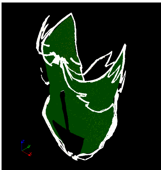
Figura 6.3: Condicions de contorn aplicades en la simulació, de color verd les cares de pressió i de color blanc els volums que envolten la paret abdominal amb càrrega nul·la.
