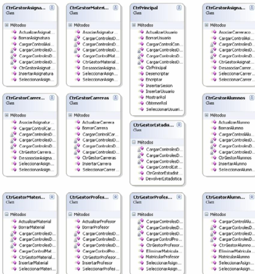
Figura 14 – Diagrama de clases del diseño del controlador de la aplicación
