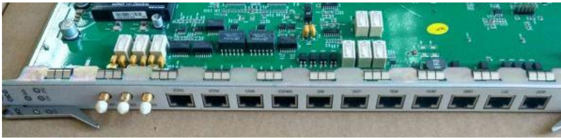
Imagen 51: Tarjeta de alarmas externas CICG para ZXA10 C300 [51A]
