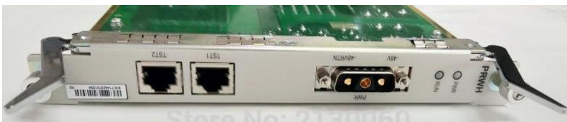
Imagen 50: Tarjeta de alimentación PRWH para ZXA10 C300 [50A]
