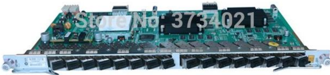
Imagen 49: Tarjeta PON interface GTGH para ZXA10 C300 [49A]
