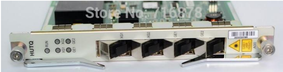
Imagen 48: Tarjeta uplink 10G HUTQ para ZXA10 C300 [48A]
