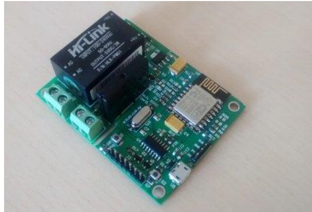
Il·lustració 6: WIFI ESP8266 SSR Board
