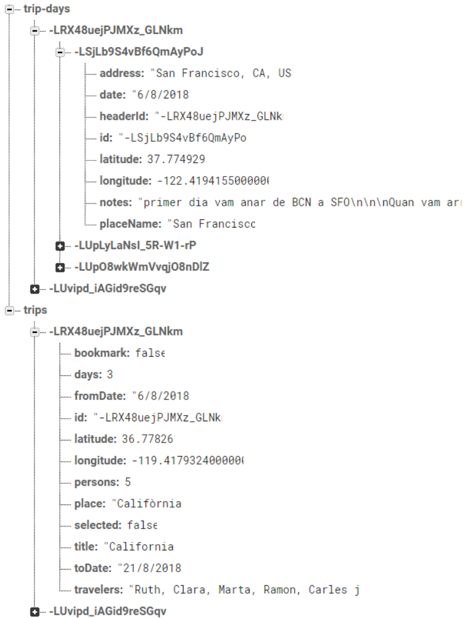
II-Iustració 53 Estructura Firebase Realtime Database
