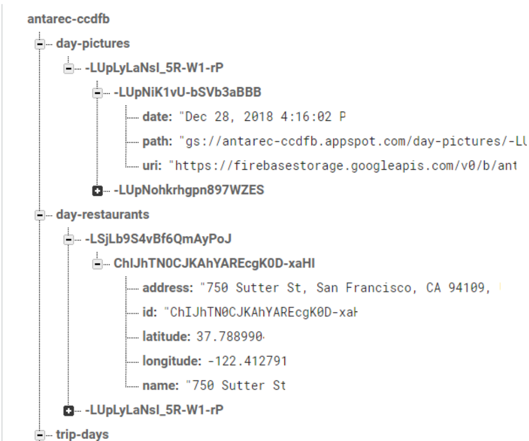
II-Il·lustració 54 Estructura Firebase Realtime Database II
