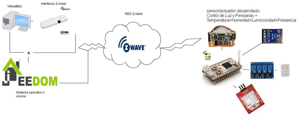
**Figura 28: Diagrama funcional dispositivo desarrollado Z-Uno**
