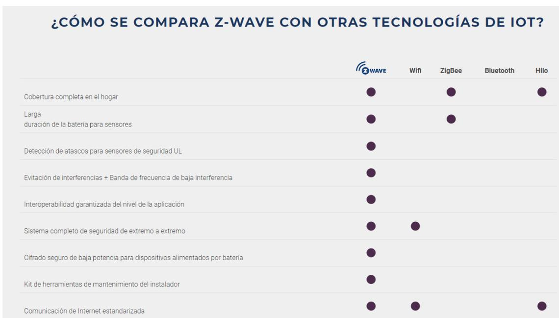
Figura 10: Figura comparativa Z-wave, ZigBee y WiFi
