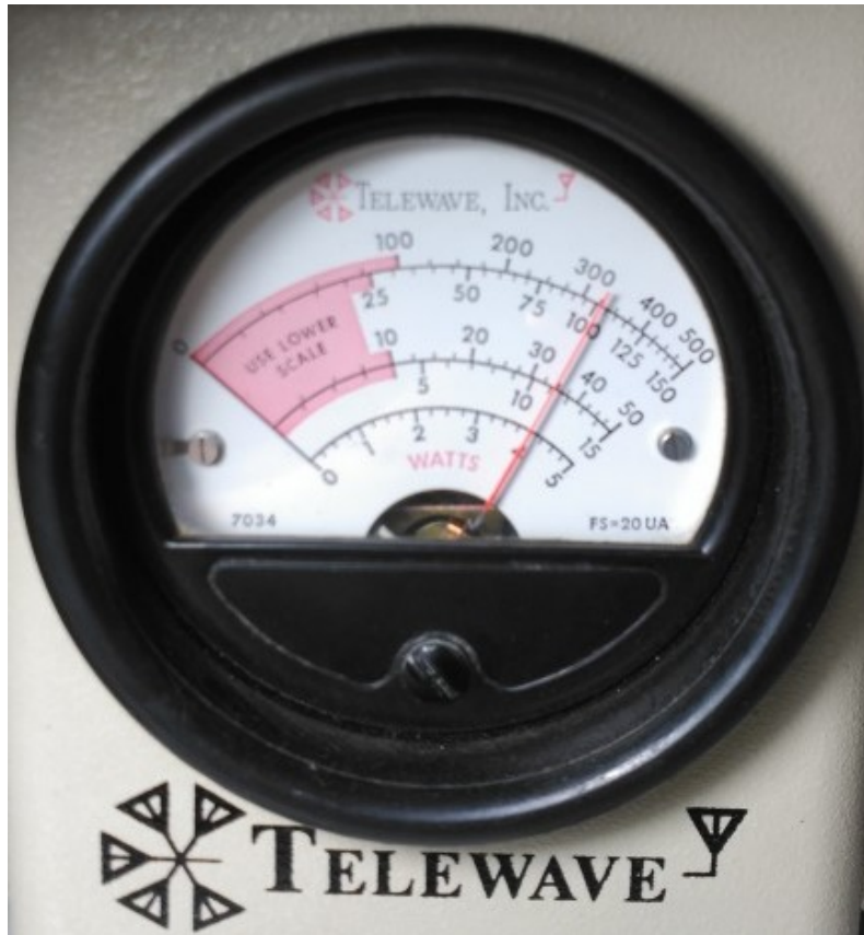
Fig. 21. Resolución del medidor 0.25W (escala de 5W)
