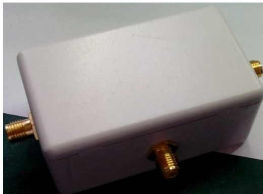
Fig. 31. Puente de pérdidas de retorno [29]
