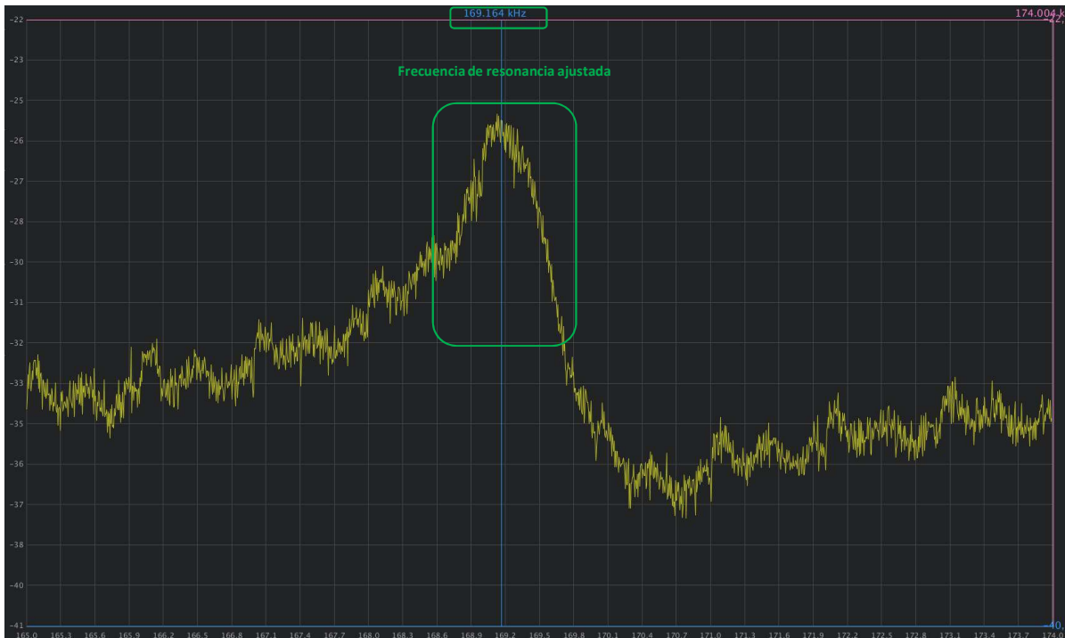
Fig. 42. Ajuste de la frecuencia de resonancia con el receptor SDR
