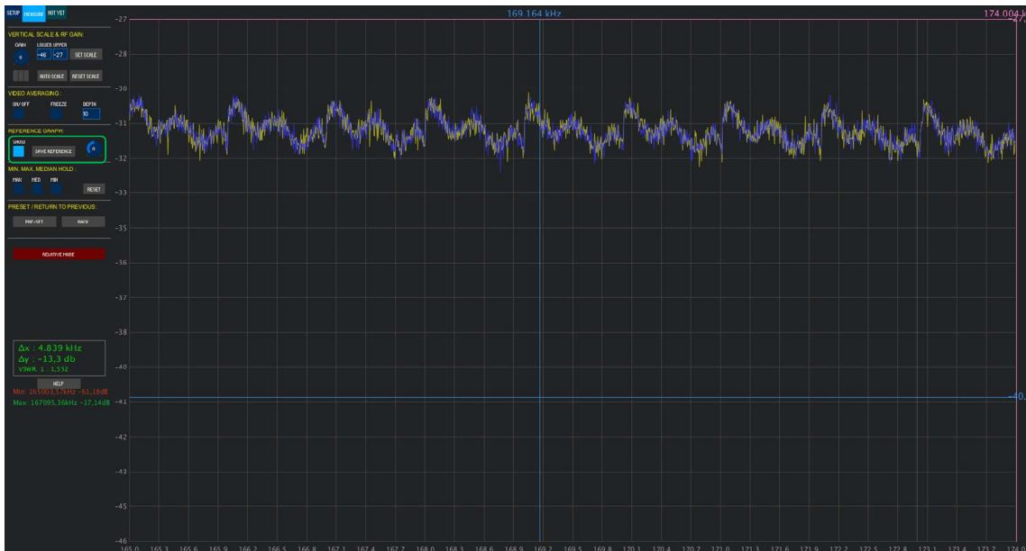
Fig. 44. Medida del ruido entregado por el generador, o nivel de 0
