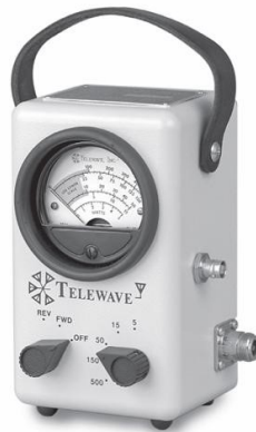
Fig. 16. Medidor de potencia directa y reflejada Telewave 44AP [23]
