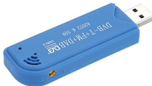
Fig. 30. Receptor SDR para captación de TV digital [28]
