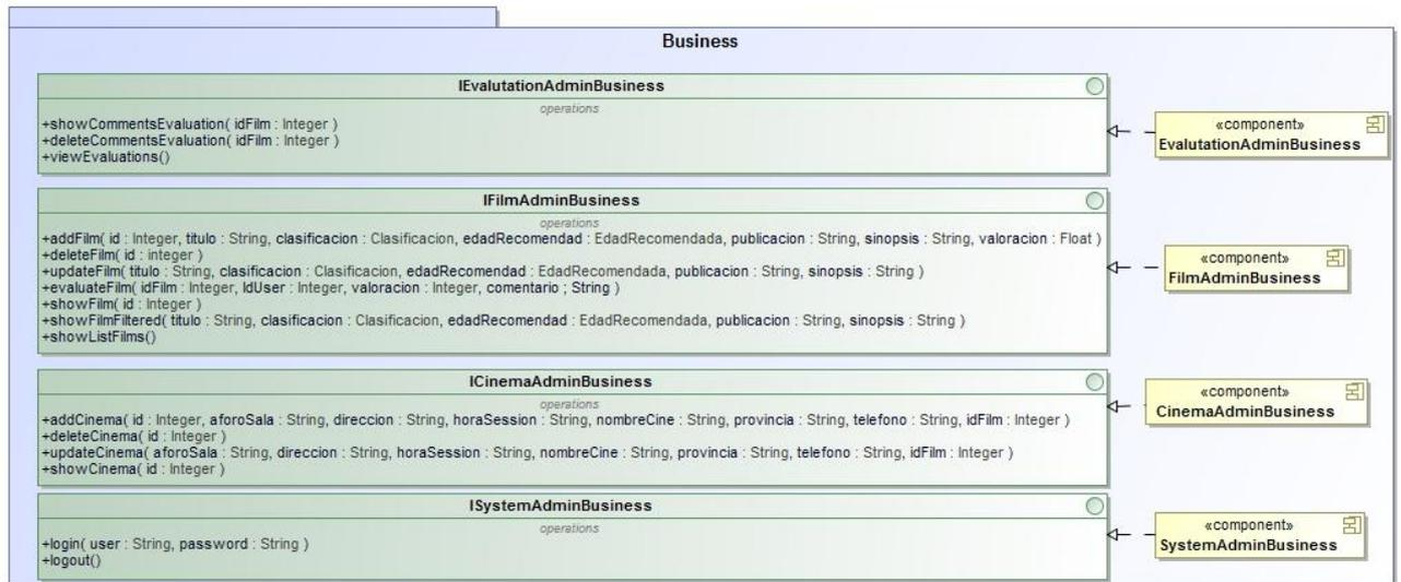
Ilustración 19 - Diseño de los Componentes para la capa de Negocio.
