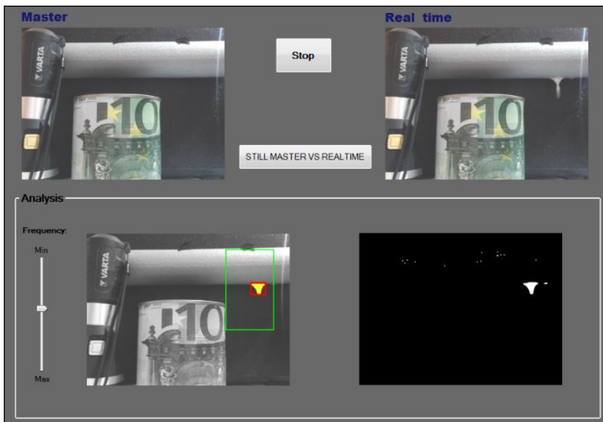
Figura 32. Detecció d'una fuita d'oli lubricant en mode subtracció entre la imatge mestre fixa i la real.
