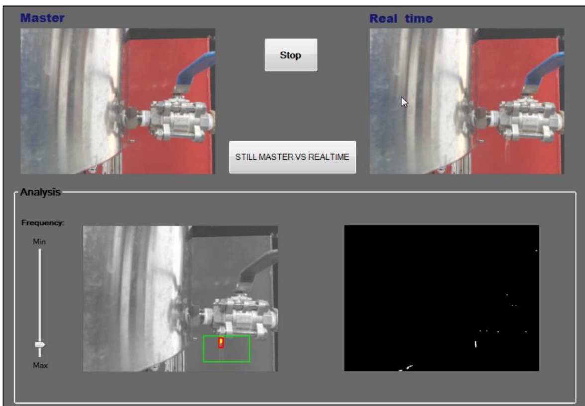
Figura 36. Detecció d'una fuga d'aigua en mode subtracció entre la imatge mestre fixa i la real.
