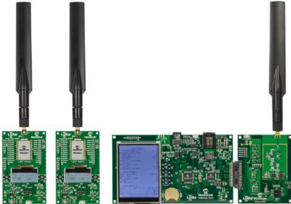
Figura 53. Gateway Microchip DV1644140-2 para redes LoRaWAN [95]
