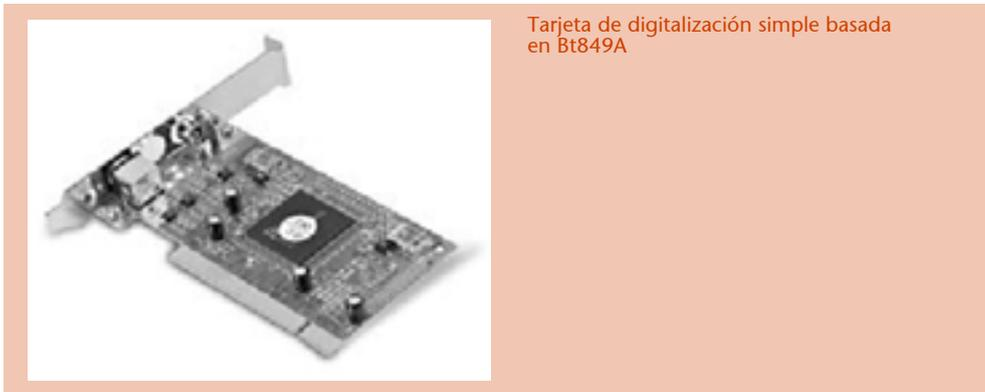
Las comunicaciones de datos y programas entre la tarjeta de digitalización y el ordenador se realizan mediante el bus PCI. Este bus admite velocidades de transferencia de datos de hasta 132 *Mbytes* por segundo (tened en cuenta que son *Mbytes* y no *Mbits*), lo que permite un flujo más que suficiente, al menos si todo funciona de forma correcta, para el intercambio de vídeo digital entre la tarjeta y el ordenador.
