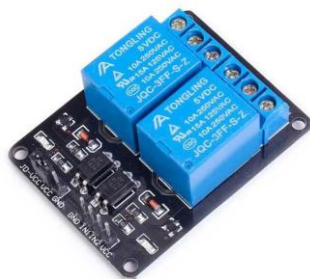
Figura 23. Módulo de dos relés de 5VDC
