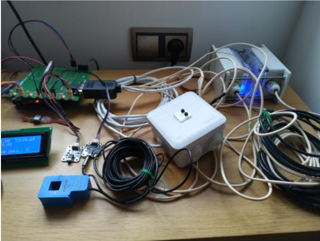
Il·lustració 3. Prototip MCU amb sensors de lux i corrent connectats
