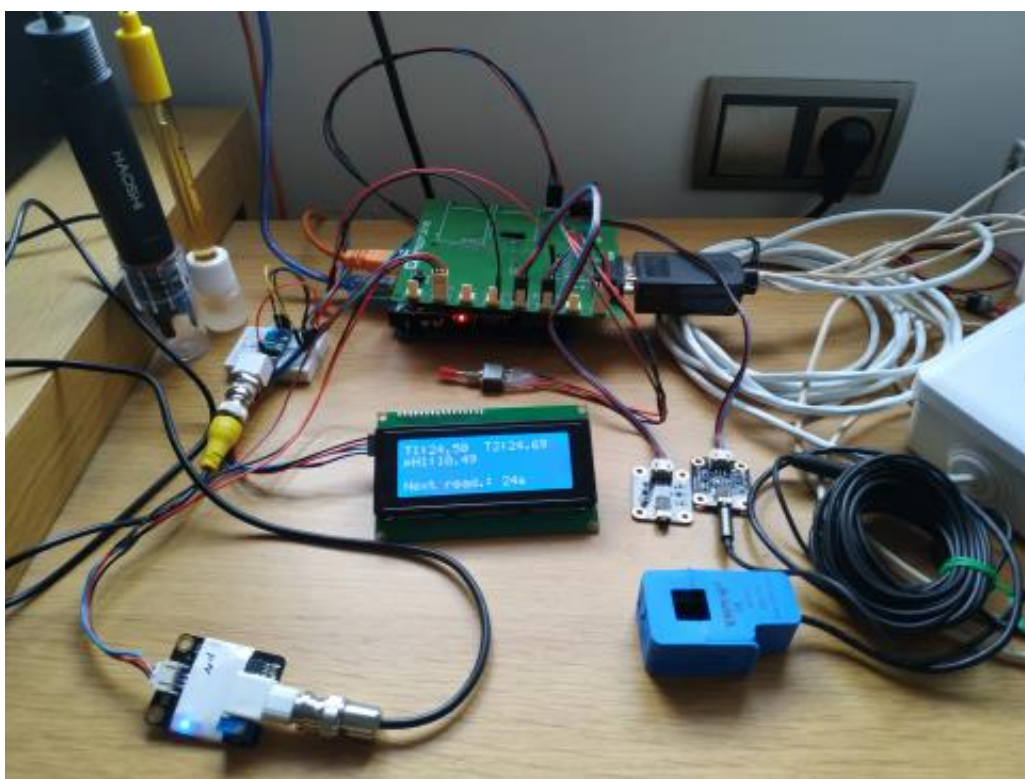
Il·lustració 2. Prototip MCU amb sensors de ORP, pH, Lux i corrent connectats
