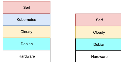
Figura 15: Arquitectura de un nodo usando Cloudy y Kubernetes.
