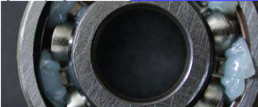
Figura 8 Como poner grasa a un rodamiento ( https://www.klueber.com/ecomaXL/files/Waelzlager-SP.pdf )
