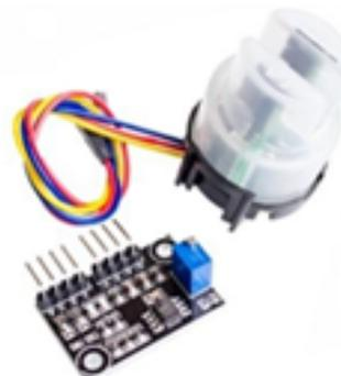
FIGURA 7. SENSOR TURBIDEZ DEL AGUA [42]
