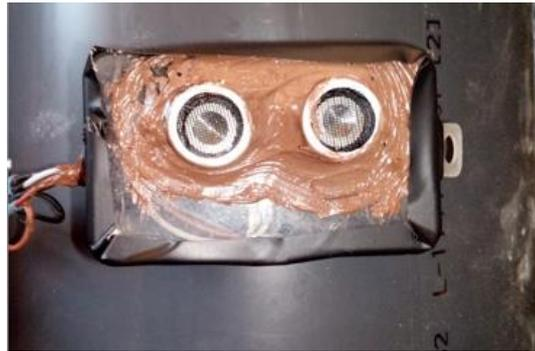
FIGURA 76. SENSOR DE NIVEL EN EL PROTOTIP
