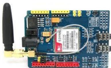
FIGURA 53. TARJETA SIM900 GSM/GPRS [39]
