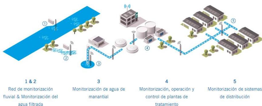
FIGURA 5. ESQUEMA DE MONITORIZACIÓN EN GRANDES REDES DE AGUA [9]
