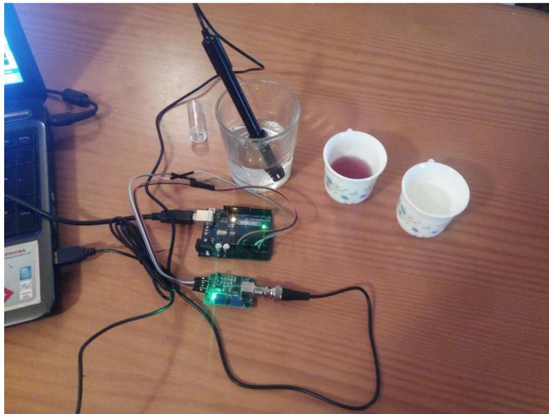
FIGURA 19. PUEBAS SENSOR DE PH
