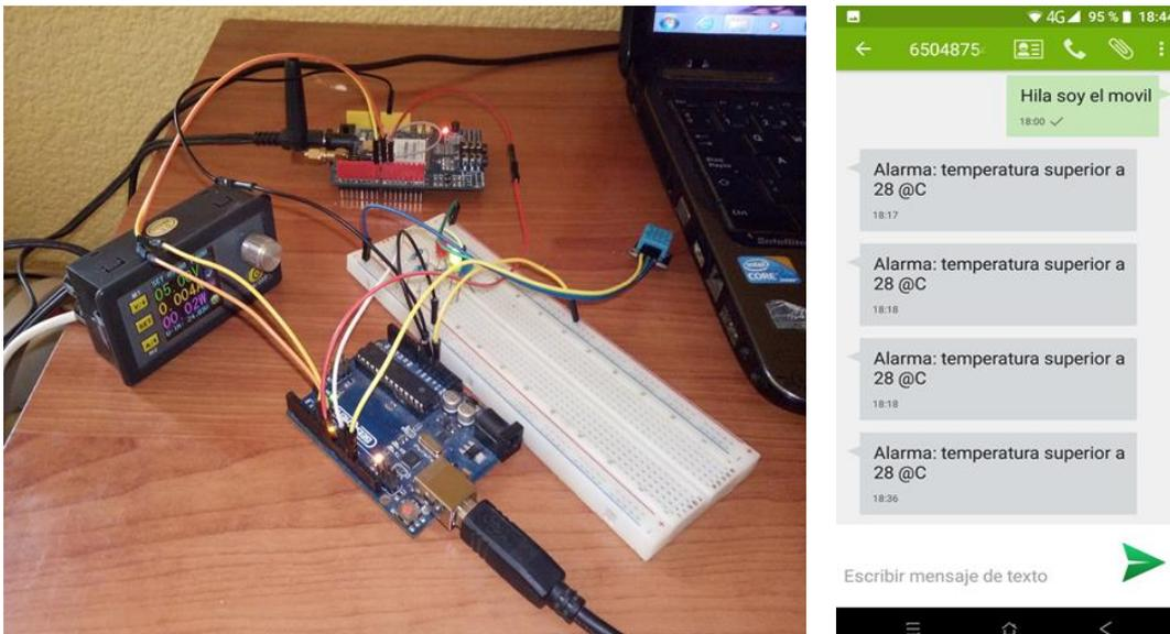
FIGURA 75. PRUEBAS CON SENSOR DHT11 Y ENVÍO DE SMS
