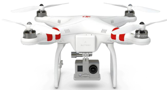
Figura 30: Dron DJI 1 que usa la banda de 2,4 GHz en su enlace de comunicaciones. Fuente: [61]
