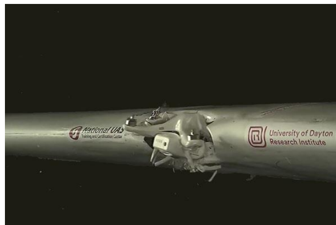
Figura 4: Daños producidos por un dron al colisionar con un ala de avión. Fuente: [31]
