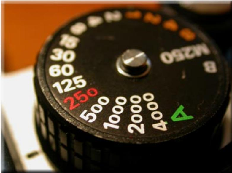
En la imagen adjunta se observan los valores en el anillo de velocidades de una réflex. En blanco las velocidades inferiores a 1 segundo, en rojo la mínima velocidad para asegurar la sincronización con el flash, y en amarillo las velocidades iguales o superiores a un segundo.
