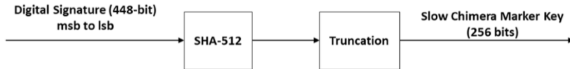
Ilustración 23. Generación de marker key en protocolo slow-channel de Chimera. [17]
