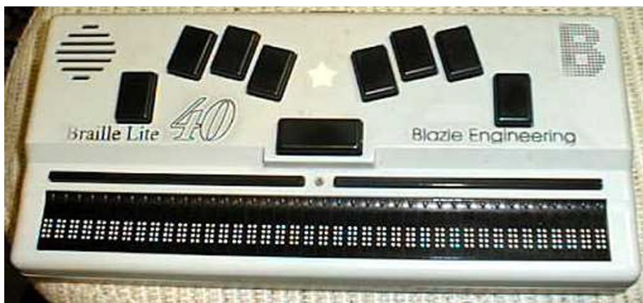
Figura 2. Braille Lite, dispositiu que inclou una línia Braille de quaranta cel·les
