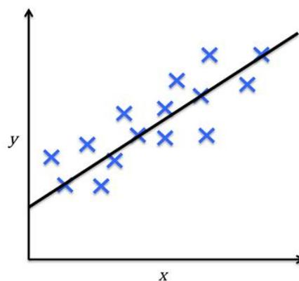
Un ejemplo de regresión lineal: dados  $X$  e  $Y$ , ajustamos una línea recta que minimiza la distancia (con algunos criterios como la distancia al cuadrado promedio (SSE)) entre los puntos de muestra y la línea ajustada. Luego, usaremos la intercepción y la pendiente aprendidas, de la línea ajustada, para predecir el resultado de los nuevos datos.
