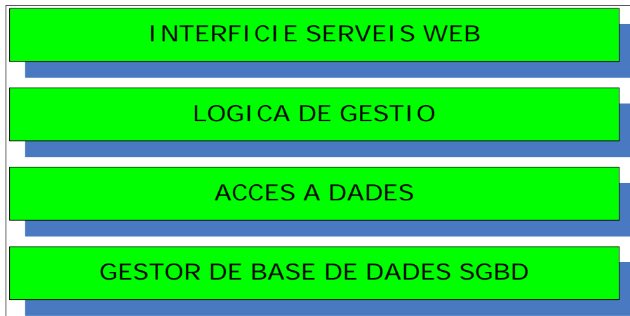
Figura 4.1.2.2-1 Vista lògica de l'aplicació servidor.
