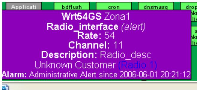
Fig. 4.11: Detalle representación gráfica de la interfaz de parámetros de radio del acces point WRT54GS.
