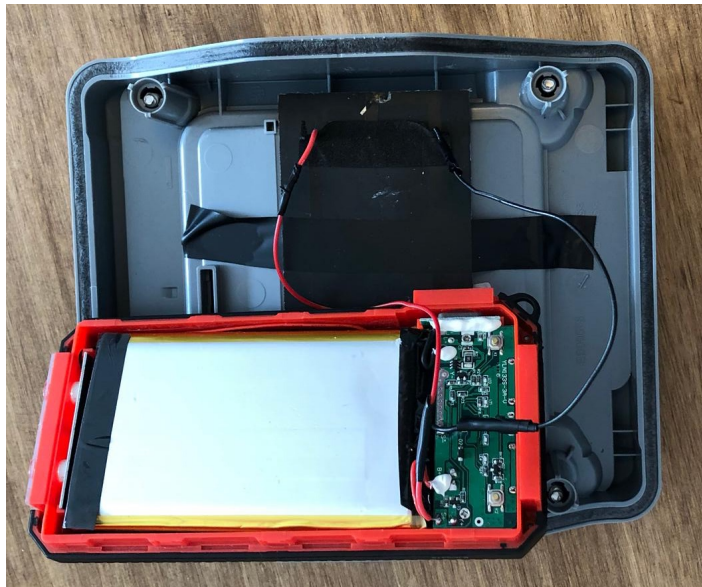
Il·lustració 31 - Instal·lació Bateria a Caixa
