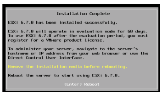
Ilustración 14. Instalación ESXi, paso 6
