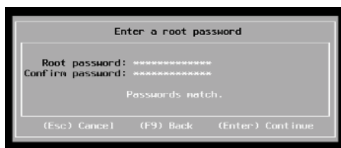
Ilustración 12. Instalación ESXi, paso 4
