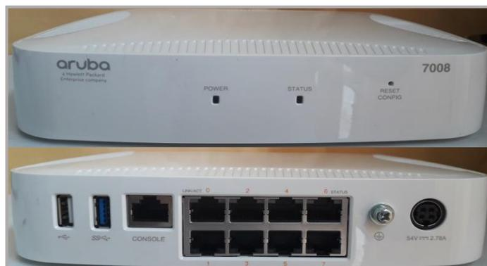
*Ilustración 61: Frontal y trasera Aruba 7008*
