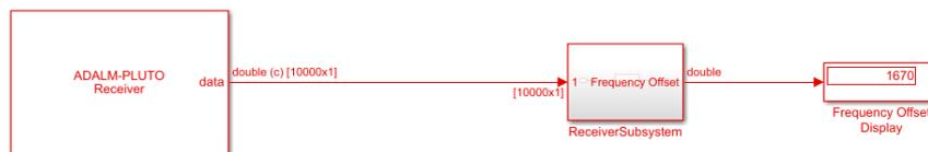
Ilustración 21 Recepción de la señal para la estimación de velocidad
