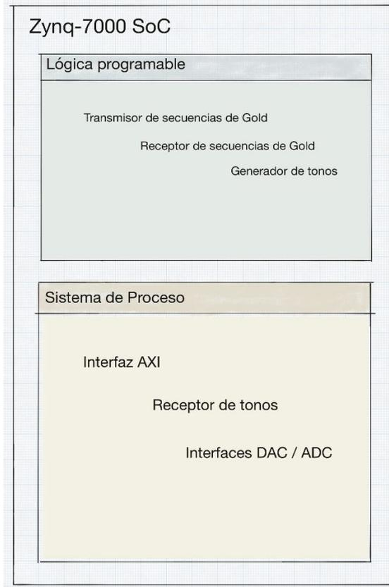
*Ilustración 41. Estructura general del Sistema.*
