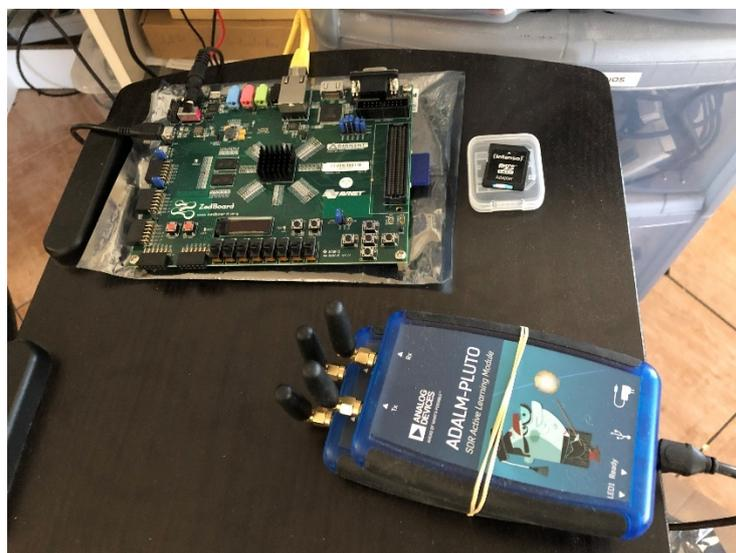
Ilustración 14 Dos Pluto en tándem junto con la placa Zedboard
