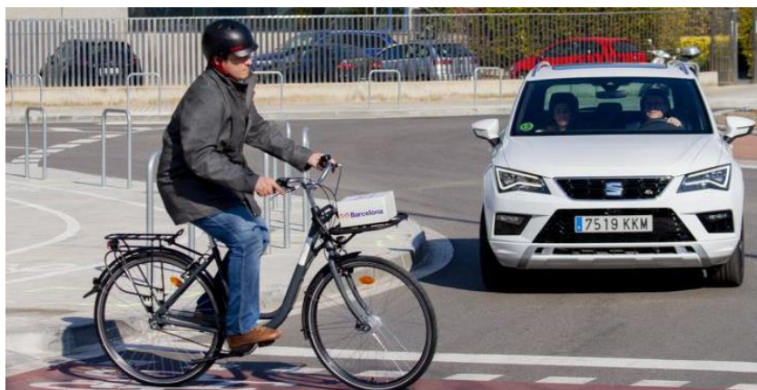
Figura. 21 Detección de un ciclista con comunicación C-V2X MWC 2019. Fuente: Ficosa [39]
