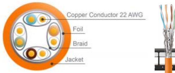
Figura 19: Construcción cable categoría 8 [19]
