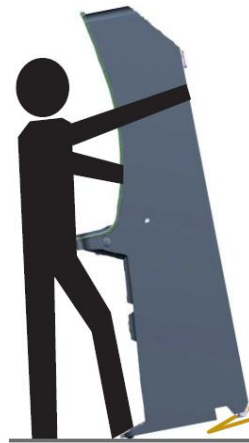
Il·lustració 13. Manipulació incorrecte en el desplaçament de màquines recreatives.
