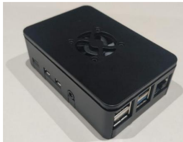
Figura 33: Raspberry Pi 4 després de muntar la carcassa
