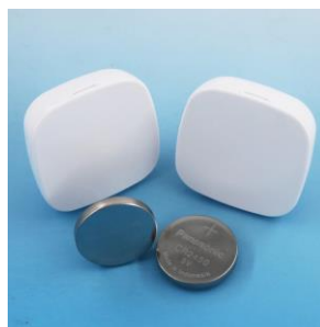
Figura 1: Dos balises BLE
