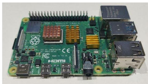
Figura 31: Raspberry Pi 4 amb dissipadors de coure i microSD
