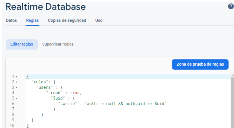
Figura 84: Firebase - Reglas de acceso a base de datos
