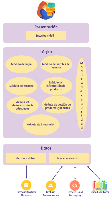
Figura 74: Diagrama de arquitectura por capas
