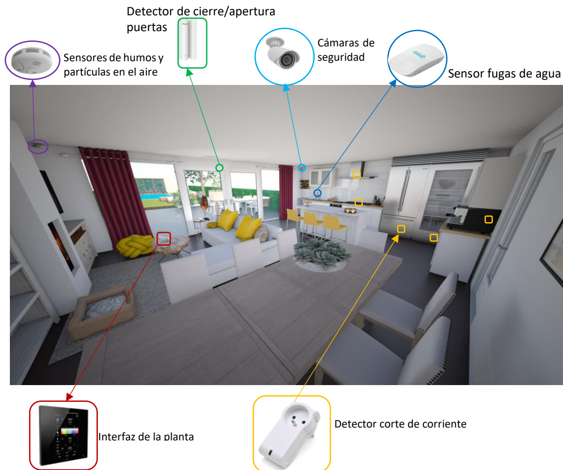
Figura 45. Sensores en el interior de la vivienda.
