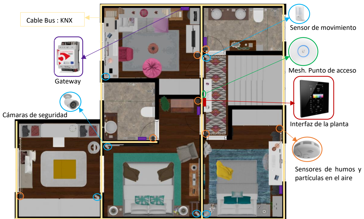
Figura 47. Interconexiones en la segunda planta
