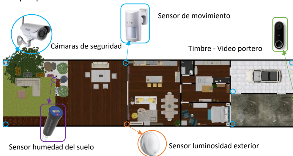
Figura 44. Sensores en el exterior de la vivienda.
