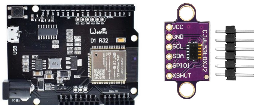
Figura 4.2: Placa electrònica HiLetgo UNO R3 D1 R32 ESP32 i sensor ToF model VL53L0X
