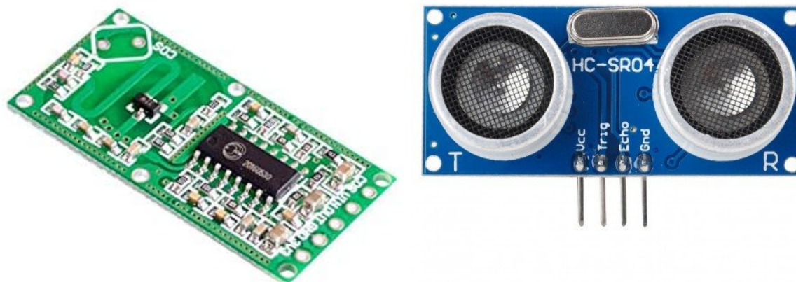
Figura 2.1: Sensor de microones a la dreta i sensor d'ultrasons a l'esquerra
