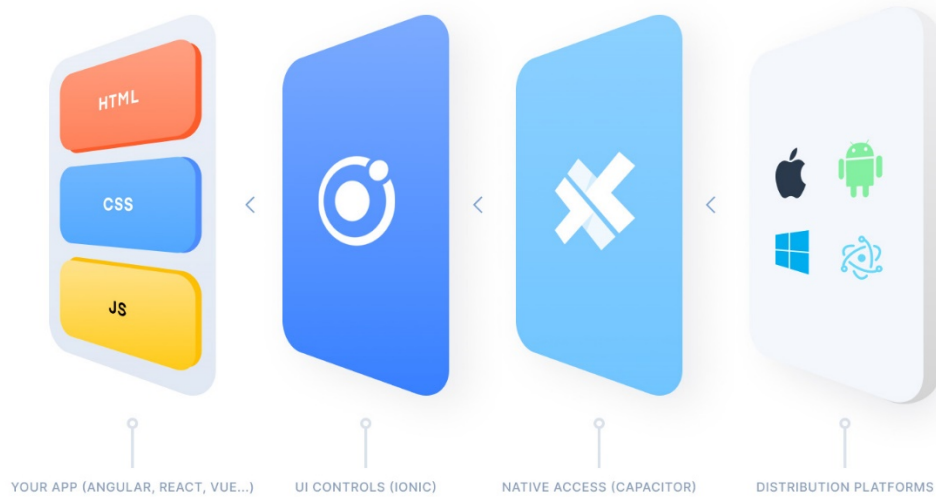
Figura 8: Layers en el cliente híbrido con capacidades nativas mediante Capacitor [40].
